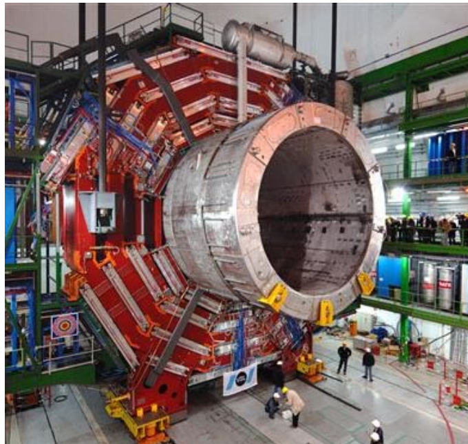
FIGURE 4.3 – L'aimant de CMS dans le hall d'assemblage en surface
